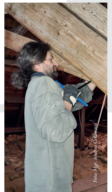
Snímání vzorku pro dendrochronologické datování
